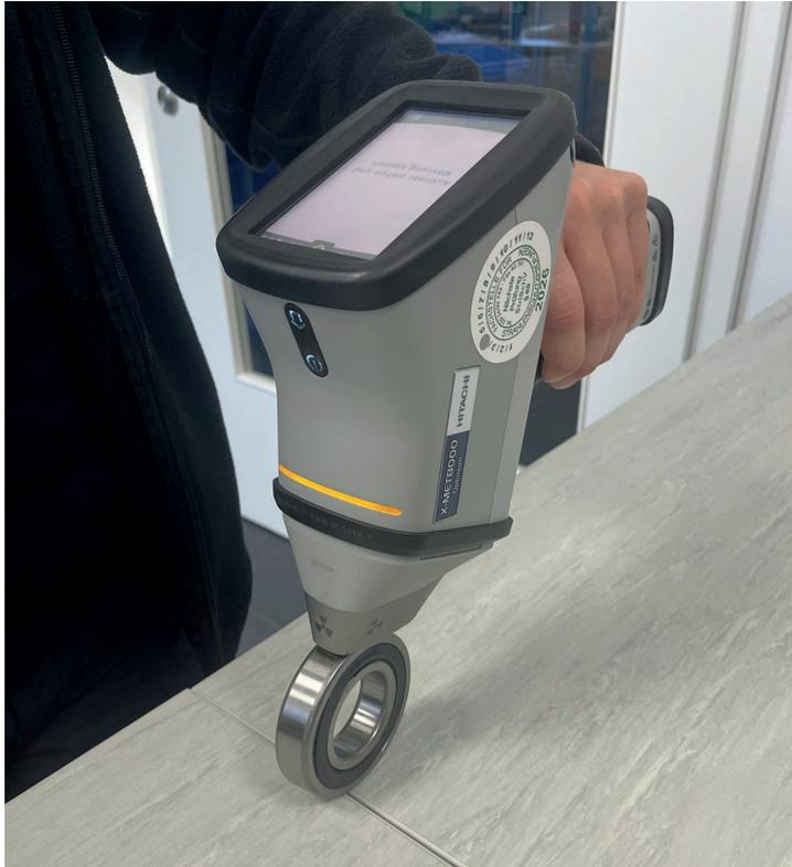
Zerstörungsfreie Analyse eines Wälzlagers mit dem RFA Handgerät X-MET8000
