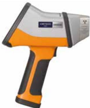
本手持式XRF光谱仪可提供快速无损分析，以及精确的化学和牌号识别。通过将高性能X射线管与大面积硅漂移探测器SDD相结合，甚至可在几秒钟内处理要求最高的应用。对于铸造厂而言，其非常适用于金属废料分拣、循环材料分析、铁合金或其他熔体校正用材料的验证。
