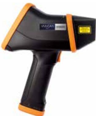
**Vulcan**是世界上最快速的手持式金属分析仪之一，可让您在一秒内鉴定各种合金。由于其能够分析Be, Mg, Al以及Si等轻元素，因此非常适合铝铸造厂。对于铸造厂而言，其非常适用于金属废料分拣、循环材料分析和其他熔体校正用材料。
